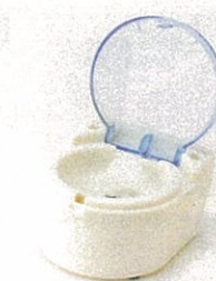
図2 小型遠心機：血液分離機(セパロン) 最高回転数：7,000 rpm(約2,000 G) 適用内容：350 \mu l (1本×350 \mu l) 重量：167 g(電池未装着時) 外形寸法：85(W)×97(D)×58(H)mm 電池：DC 3 V(単三アルカリ乾電池×2本)
