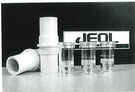
BioMajesty 純正B型サンプルカップに左から15 \mu L 50 \mu L 100 \mu Lの検体を分注。
